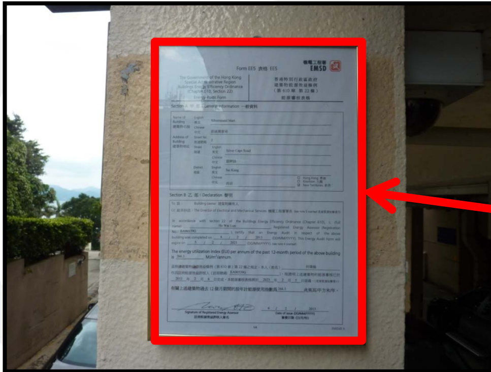
在建築物的主要入口展示有效的能源審核表格
