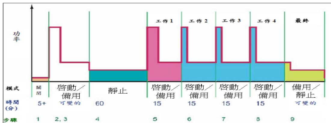
圖 1 為測量程序的圖形表示方式。請注意，對於具有較短預設延遲時間的產品，可在 4 件工作的測量過程中納入「靜止」模式時段，或在步驟 4 的「靜止」測量過程中納入自動關閉時段。此外，具列印功能且僅具有一個「靜止」模式的產品，在最終期間不會有「靜止」模式。
