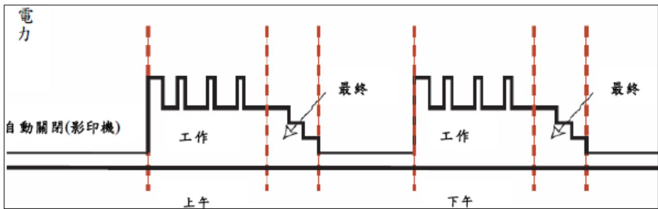
圖 2 以一個速度為 8 ipm 的多功能辦公室設備為例，以圖形方式顯示該設備在一天內的工作情況。該設備早上進行 4 件工作，下午進行 4 件工作，早上與下午各有一段最終期間，而在工作天結束後及整個周末都處於自動關閉模式。在一天中有一段假設（但無明確顯示）存在的午膳時間。本圖並未依據時間比率繪製。如圖所示，每件工作的間隔時間為 15 分鐘，而 8 件工作則可分為兩個群組。不管長短，一天內總會有兩個完整的「最終」期間。
