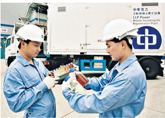
由於變壓器遍佈九龍及新界多個地點，因此這個絕緣油再生設備特別設計為 20 呎長的流動貨櫃車模式，免卻了運送絕緣油的時間和成本之餘，更能切合香港寸金尺土的限制。
