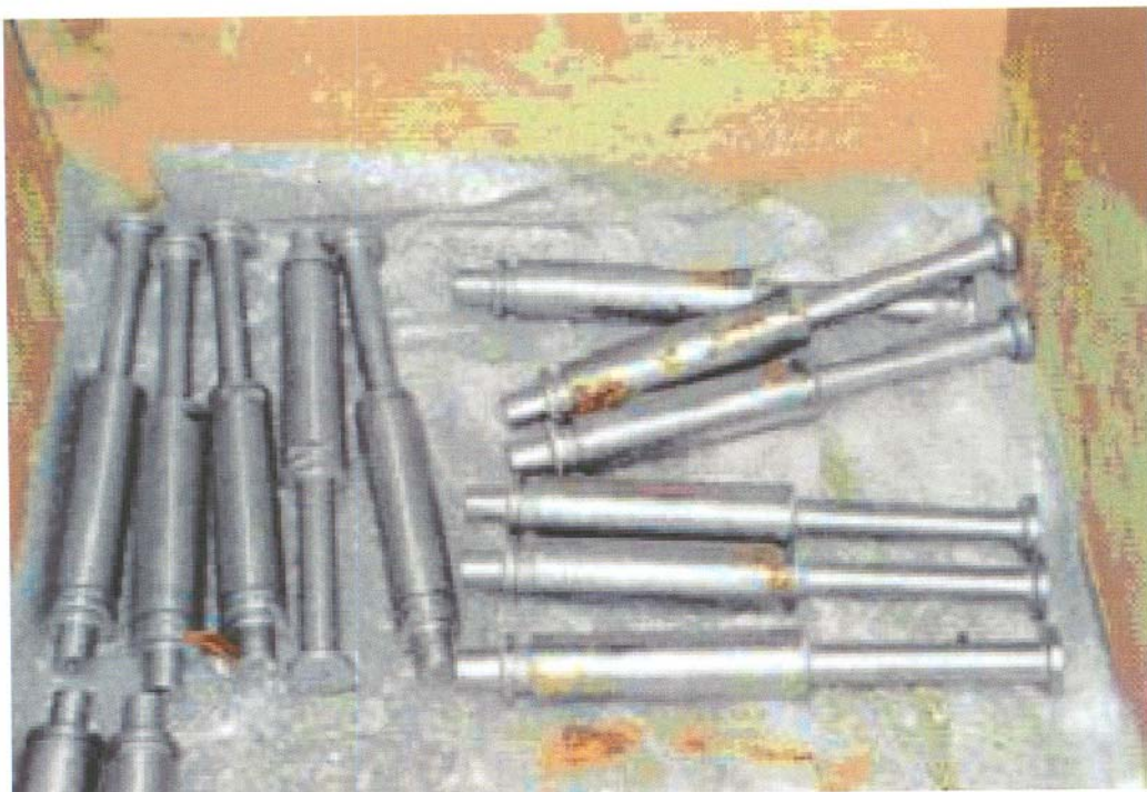
圖 19－ 置於車廂儲存庫內出現銹蝕的零件
