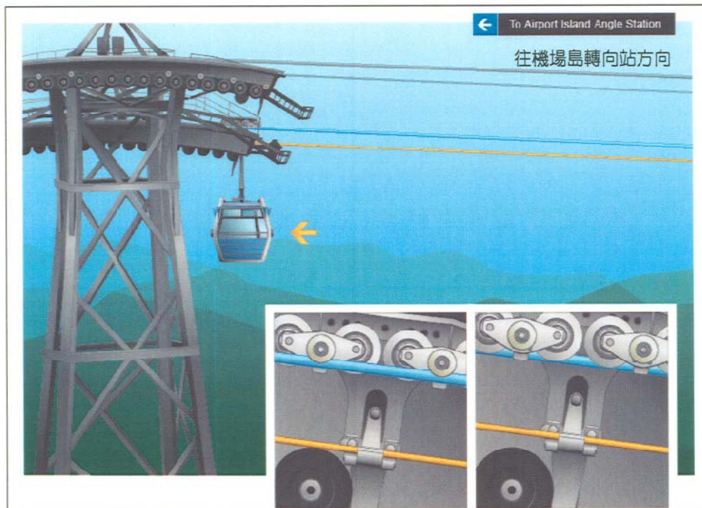
圖 13— 脫軌的 21 號車廂移位後到達 2B 號塔（左邊小圖詳細顯示吊架移位情況，右邊小圖顯示其正常位置）
