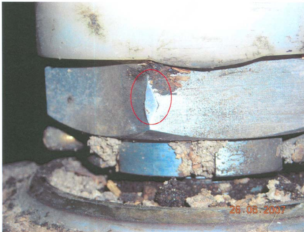
圖 11— 車站導向滑輪的鎖定螺母下方發現磨損痕跡
