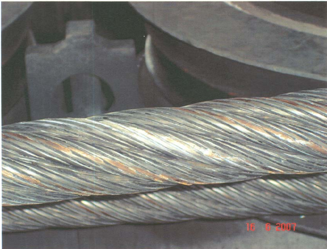
圖 8— 牽引纜表面有輕微損壞
