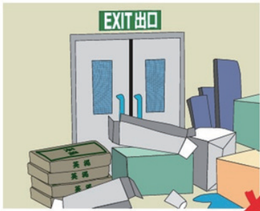
在走火通道堆放大量裝修物料，造成阻塞。
