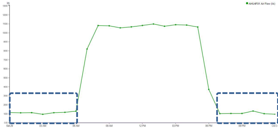
圖 4.2.5(f)送風機超時操作數據示例
