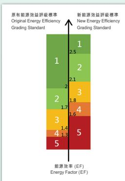
抽濕機的原有及新能源效益級別標準比較能源效率(EF)愈大，表示抽濕機約能源效益愈高。
