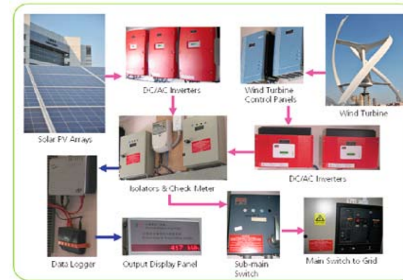
太陽能及風能混合發電系統路線圖 Block Diagram of the Hybrid System
