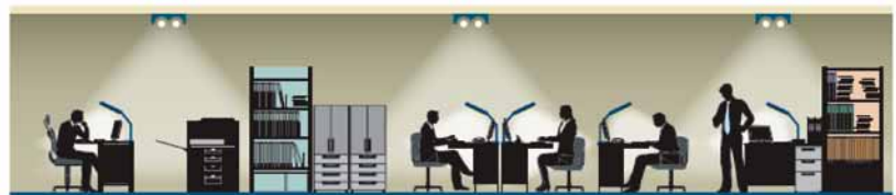
示意圖顯示一個一般的工作照明系統，它的辦公室的环境燈光減少，並在工作範圍內配置輔助的燈具
