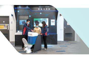
我們研發的物聯網智能馬桶清潔系統在日內瓦國際發明展奪得金獎。 清潔機械人以影像分析馬桶的清潔狀況,並利用內置刷頭執行不同程 度的清潔工作,確保洗手間清潔衞生,同時減低清潔人員接觸病毒的
