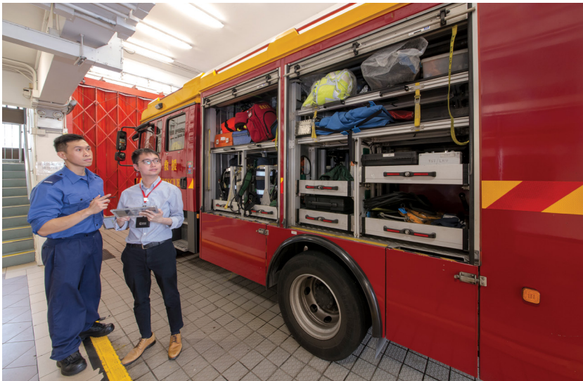
機電署與消防處共同研發的資產管理系統，運用5G和無線射頻識別技術，實時監察消防車上救火工具和救援設備的可用情況、狀態和存放位置，有助有效管理大量不同類型的資產，以及提高消防員的職業安全 and 健康水平。
