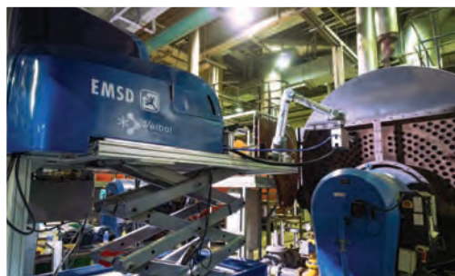
智能鍋爐維護機械人 Smart Boiler Servicing Robot
