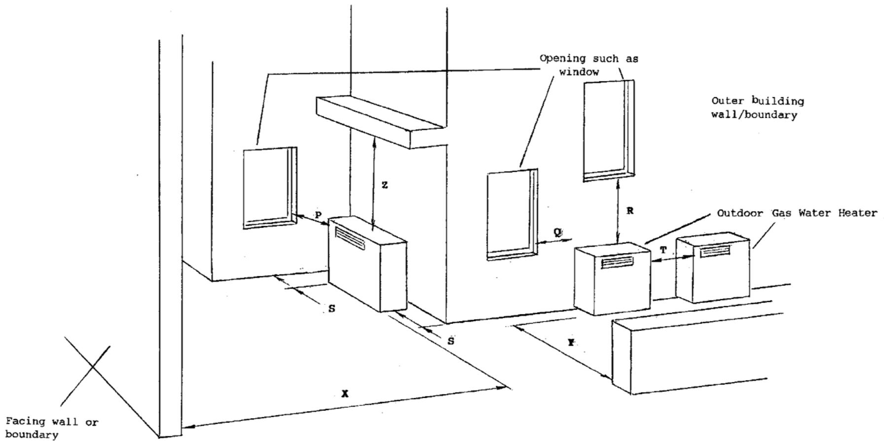
(d) Figure 2 : Pictorial View showing Minimum Separation Distances
