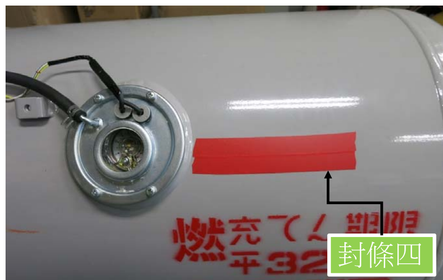
封條四：燃料缸石油氣錶蓋側 (以提示錶蓋內的封條(即封條三))
