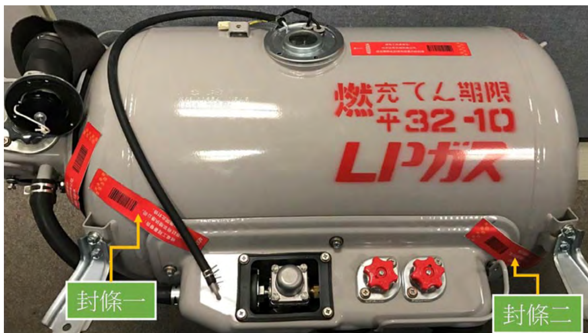
圖十八：紅色保安封條（由註冊氣體供應公司在石油氣燃料缸工場內貼上）
