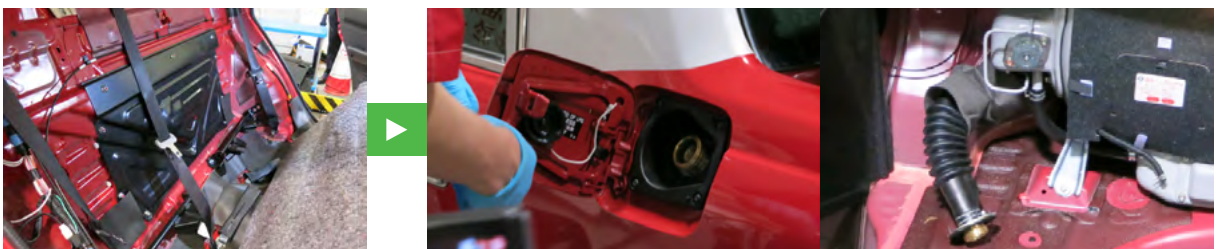
圖十五：石油氣燃料缸拆卸步驟
