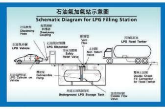
脫落連接保護器-石油氣加氣機上的注氣軟候,設有脱落連接保護 器。當石油氣車輛在加氣時被意外地駛離加氣機,注氣軟喉會在脱 落連接保護器的位置脱開並自動關閉,以防止軟喉受到損毀而導 致石油氣洩漏。
