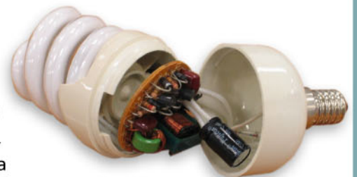
收藏在外殼之中的電子鎮流器 The integrated electronic ballast is tucked inside the casing
