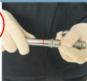
第三步: 划线 用记号笔在管子上划线,表明插入的深度。
