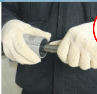
第二步: 去毛刺 用工具将管端上的毛刺去除,以防止金属毛刺划伤密封材料。
