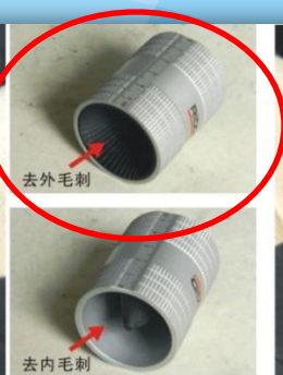
第二步: 去毛刺 用工具将管端上的毛刺去除,以防止金属毛刺划伤密封材料。
