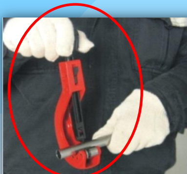
第一步: 切管 用工具将管子切到合适的长度。
