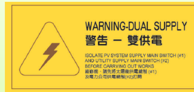
雙重供電電源的警告牌
