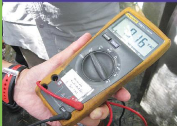
圖 2：員工使用測試設備來驗證機器的能源（電源）是否被完全切斷或消除。
