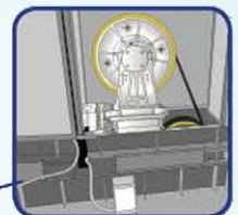
2. 為制停系統安裝防止機廂不正常移動的裝置
