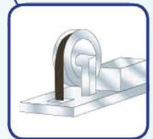
3. 加裝防止機廂向上超速裝置
