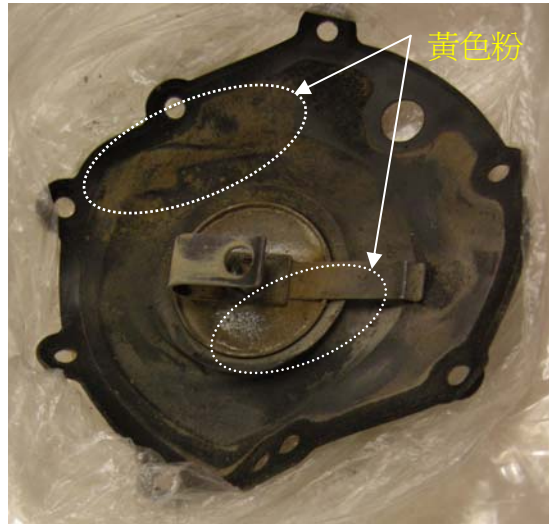
圖 5.2 - 黏附在氣化器初級氣室氣閥的
