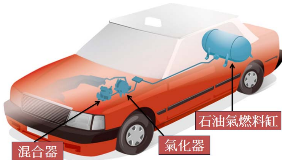
圖 6.1 - 石油氣車輛上的燃氣系統
