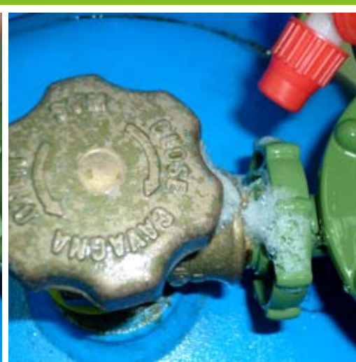
8. 以逆時針方向開啟石油氣瓶的瓶閥，並即時用肥皂水塗於瓶閥與調壓器之間的駁口，若接駁正確，接駁口該沒有氣泡；
