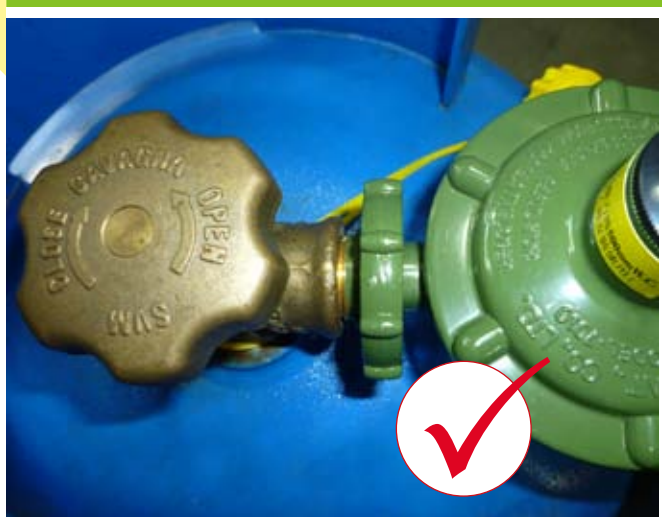
7. 嘗試用手輕力拉出及轉動調壓器，以測試是否緊接；氣瓶瓶閥與調壓器之間應扣緊，沒有任何虛位方為正確；
