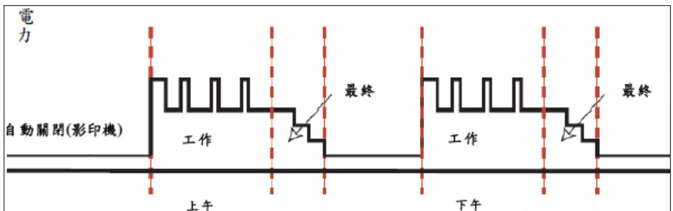
圖 2 以一個速度為 8 ipm 的打印機為例，以圖形方式顯示該設備在一天內的工作情況。該設備早上進行 4 件工作，下午進行 4 件工作，早上與下午各有一段最終期間，而在工作天結束後及整個周末都處於自動關閉模式。在一天中有一段假設（但無明確顯示）存在的午膳時間。本圖並未依據時間比率繪製。如圖所示，每件工作的間隔時間為 15 分鐘，而 8 件工作則可分為兩個群組。不管長短，一天內總會有兩個完整的「最終」期間。
