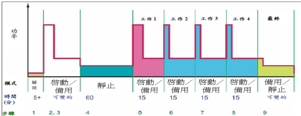
圖 1 為測量程序的圖形表示方式。請注意，對於具有較短預設延遲時間的產品，可在 4 件工作的測量過程中納入「靜止」模式時段，或在步驟 4 的「靜止」測量過程中納入自動關閉時段。此外，具列印功能且僅具有一個「靜止」模式的產品，在最終期間不會有「靜止」模式
