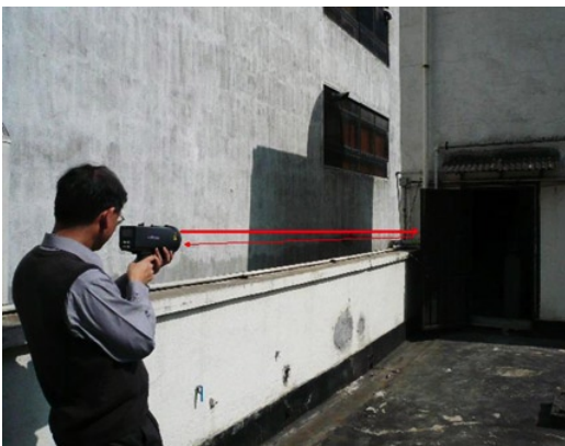
圖二 測試中的「遙距氣體檢測器」
