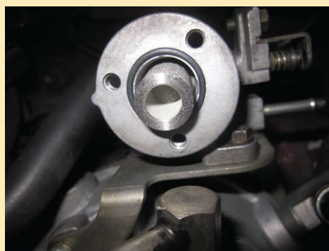
圖三：怠速燃油過濾器會在汽化過程中隔走殘餘物，如缺乏妥善保養，可導致怠速時死火。
