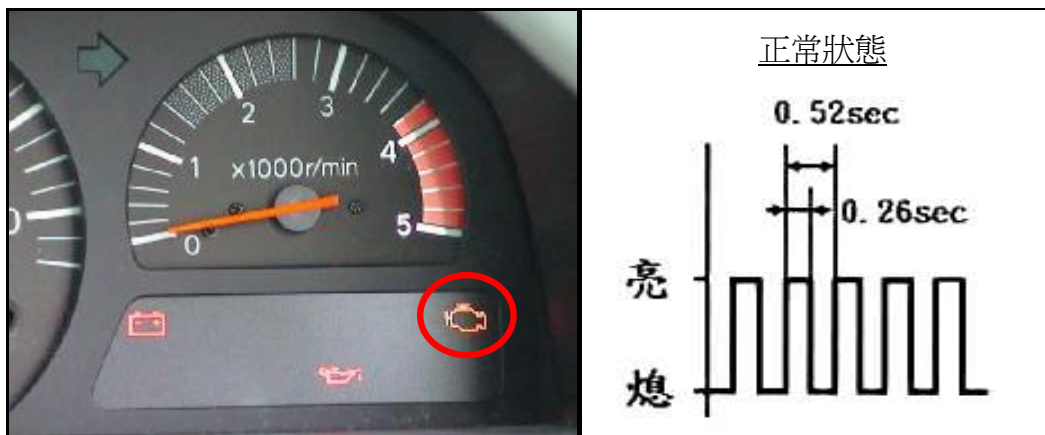
引擎故障代碼 24 和 31 的顯示方式
