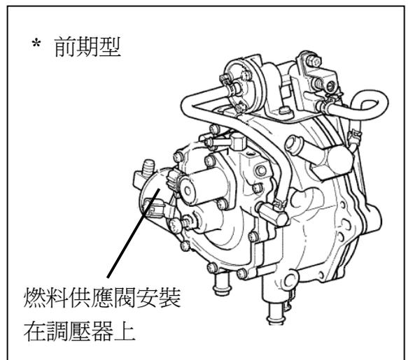
\* 前期型和後期型 LPG 調壓器的燃料供應閥安裝位置有異，但內部結構和工作原理相同
