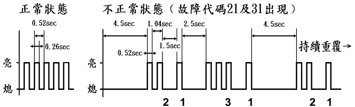
3. 轉動匙掣至 ON 位置，根據儀錶板內的引擎故障警示燈閃動次數，讀取引擎故障代碼
