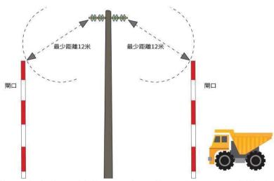
在閘口使用的高度限制裝置,與最接近的架空電纜導線之間的距離。
