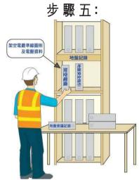
施工者應確保所有與架空電纜有關的資料(例如:架空電纜的準線、與地面距離及電壓)及供電商就安全事項所提供的意見,告知工地人員(包括監工、訊號員、機械操作員及工人)。再者,施工者應保留本守則第 6.2.4 段所述的工地會議記錄。
