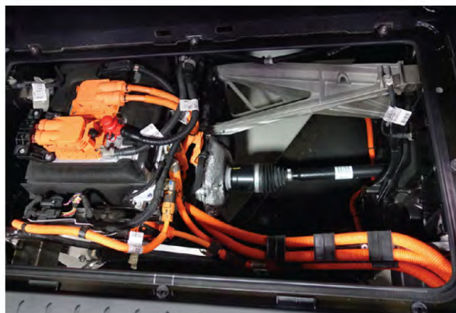
不论电动车或混能车，车内的橙色线都带有高压电源，除非受过专门训练，否则不应自行拆卸
