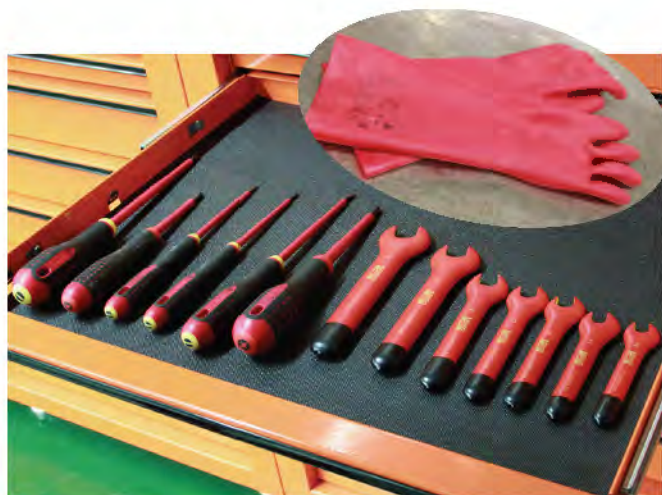
使用绝缘手套及绝缘工具进行维修，以策安全
