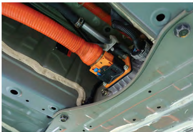
其中一种日本车款的高压电源断路器，拔除维修连接器以切断汽车高压电源
