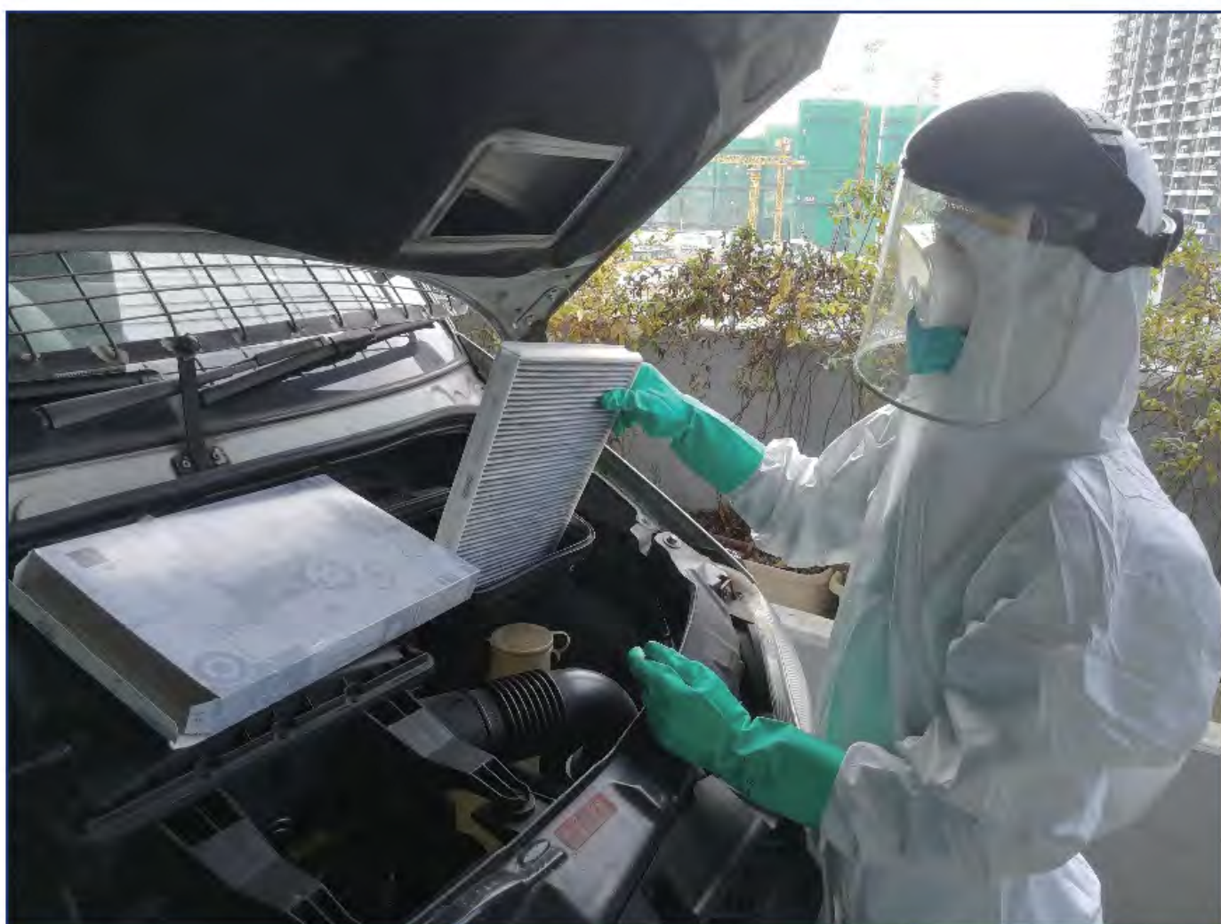
定期更换冷气回风口的过滤网
