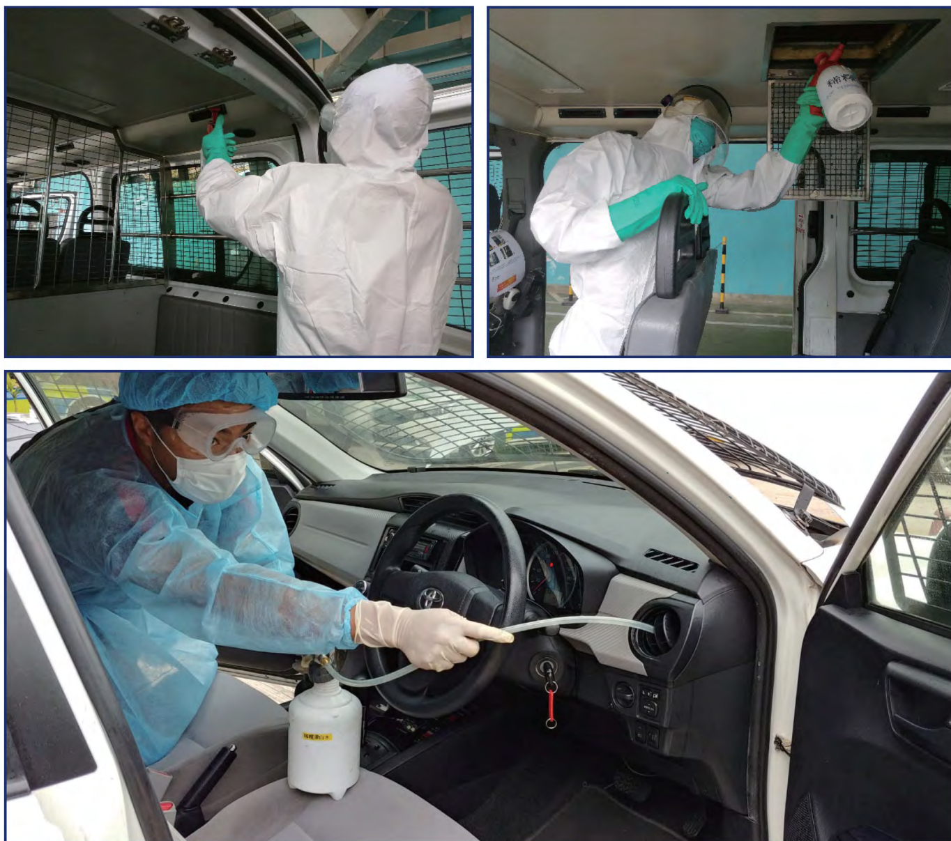
使用1:49稀释家用漂白水喷洒冷凝器及各出风口等位置
