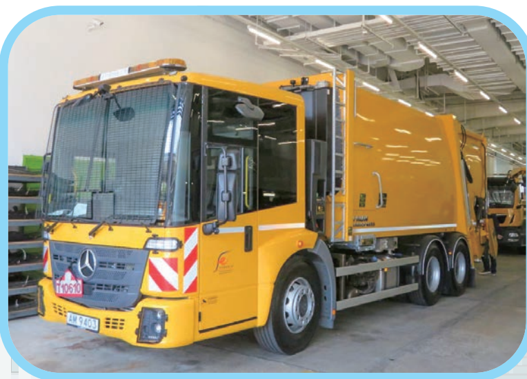
食环署于 2019 年购置的首批低地台垃圾收集车 (采用平治 Econic 底盘及 FAUN Variopress 垃圾收集斗)
