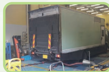
图 7 正在重型车辆测功机进行测试的中型货车
