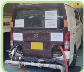
图 13 已装设 PEMS 设备的轻型货车
