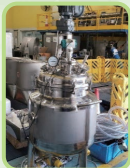
图 12 混合不同比例的生物柴油搅拌器
