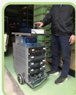
图 21 自主可移动的电动汽车充电装置
