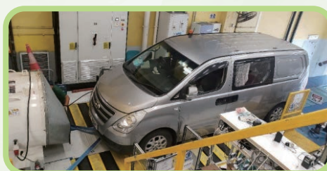
图 11 以生物柴油作燃油的汽车在底盘测功机进行测试
