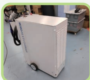
图 20 自主可移动的电动汽车充电装置
