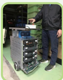
图 18 自主可移动的电动汽车充电装置
