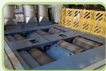
图 5 重型车辆测功机
