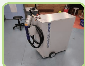
图 19 自主可移动的电动汽车充电装置
