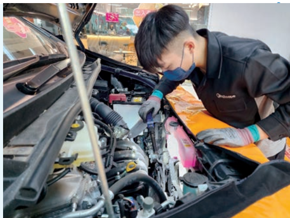
李峻轩先生在学徒训练中学习使用原厂的测试仪器，以缩短查找系统故障所需的时间。
