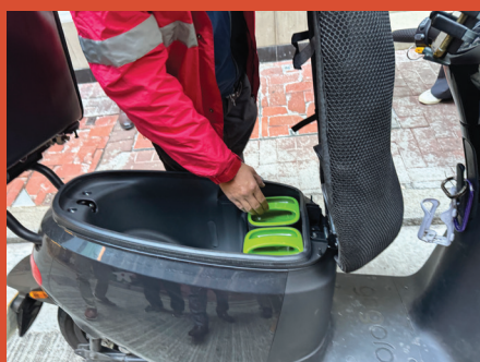
驾驶员示范从电动电单车取出电池进行充电。
