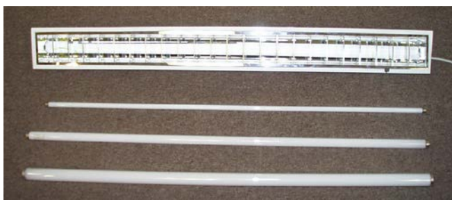
图 7 接受测试 T5 照明器的实际大小, 以及与 T8 及 T12 灯的比较
