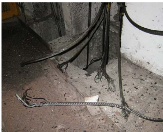
圖 3 – 升降機發動機房發現斷裂的懸吊纜索。
