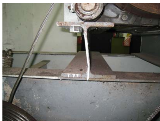
圖 5B – 工字形金屬桁樑變形放大圖。
