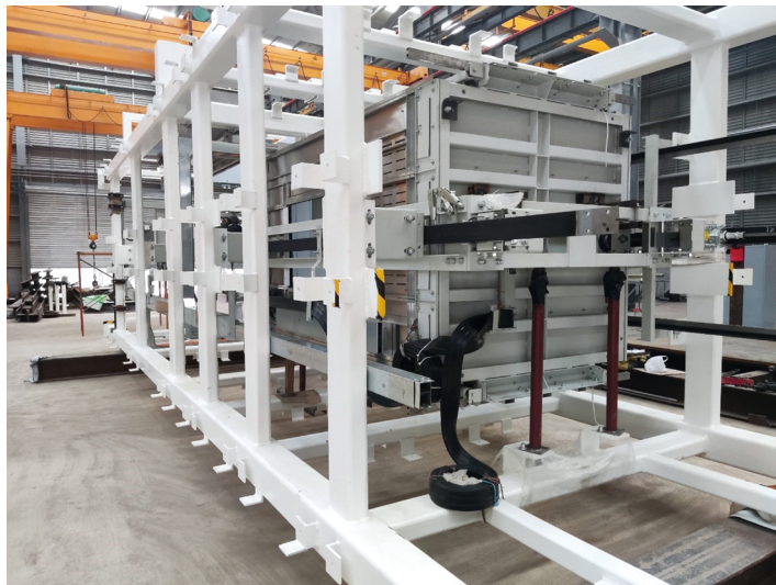
機廂預裝於井道結構支架
