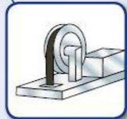
3. 加裝防止機廂向上超速裝置
