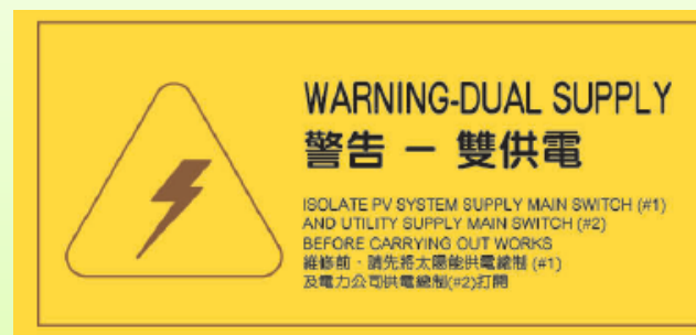
雙重供電電源的警告牌
