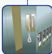
5. 加裝對講機及閉路電視系統
