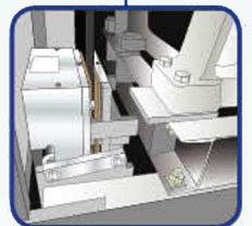
2. 為制動系統安裝防止機廂不正常移動的裝置
