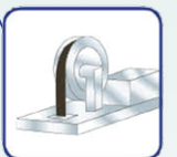
3. 加裝防止機廂向上超速裝置
