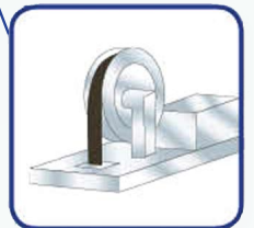
3. 加裝防止機廂向上超速裝置
