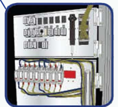
6. 安裝障礙開關掣保護懸吊纜索
