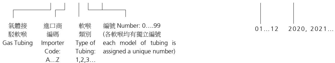
**不銹鋼鋼絲網套或鎧裝全橡膠材料低壓氣體接駁軟喉 (喉端頸環或喉身註明批准標記及使用壽命屆滿日期)**
