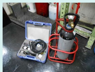
石油氣車輛喉管驅氣設備 （石油氣噴注系統）
