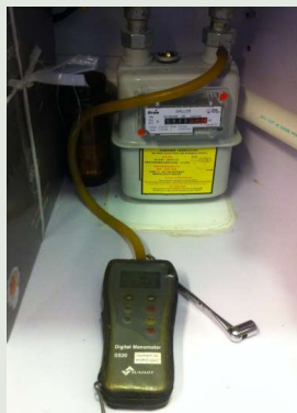
圖二：氣密測試 — 以電子壓力計量度系統壓力
