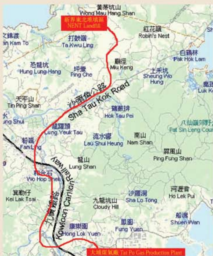
圖4 堆填區沼氣輸送管道路線圖
