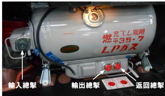
圖六：石油氣燃料缸基本結構
