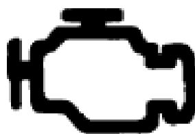
引擎故障警示燈
