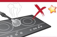
切勿使用蒸汽清潔器 清潔電磁爐。
