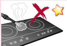
切勿使用蒸汽清潔 器清潔電磁爐。
