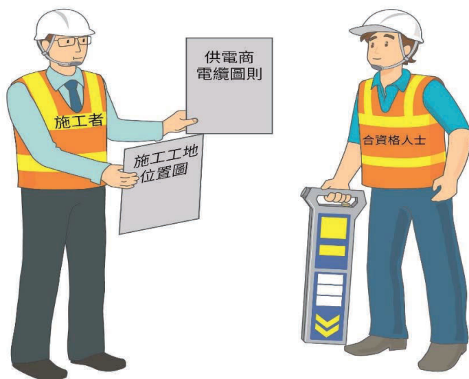
圖 3.2 - 施工者委聘合資格人士進行電纜探測工作
